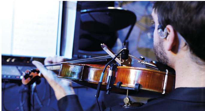
**Leichte Federspannung** Neumann MCM KK14 an einer Violine, der spezielle Schwanenhals soll eine Beschädigung des Instruments vermeiden
