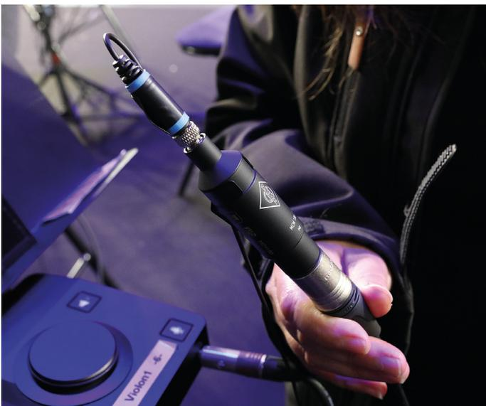
**Ausgangsstufe MCM-100** im drahtgebundenen Betrieb, bei Bedarf kann die Klinkenverbindung über einen mitgelieferten Clip fixiert werden, ansonsten soll sie sich unter Zugspannung lösen – um Schäden durch herunterfallende Instrumente zu verhindern, falls jemand aufsteht und die Verdrahtung vergisst
