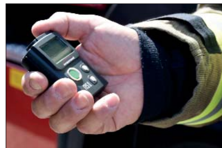
Der RES.Q ist ein Hybrid-Pager, der Pocsag- und die zellulare Mobilfunktechnik miteinander verbindet
