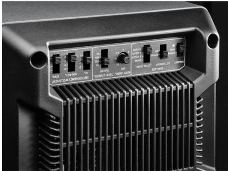
Ermöglicht wird dies durch eine DSP-gesteuerte Elektronik mit ausgeklügelten Frequenzweichen ohne die Phasenverzerrungen, wie sie analoge Filter verursachen. Der interne DSP setzt zudem neue Maßstäbe bezüglich der tonalen Konsistenz. Der KH 120 II wird mit extrem geringen Toleranzen von lediglich  $\pm 0,5$  dB gefertigt. Die Stereoabbildung ist daher messerscharf. Die Digitalelektronik
