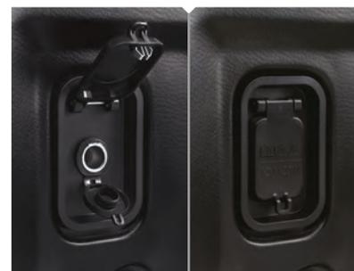
Prise électrique 12V dans la benne
