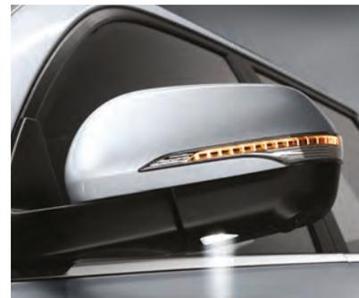
Clignotants et éclairage du sol intégrés dans les rétroviseurs extérieurs.
