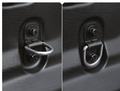
Crochets d'arrimage dans la benne
