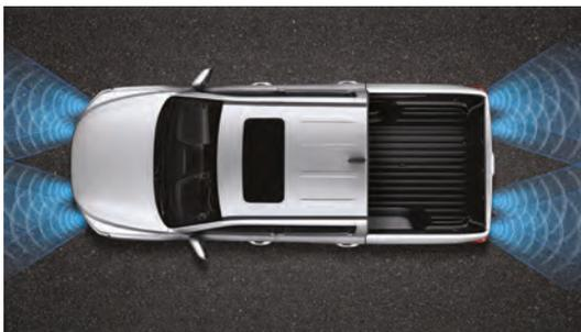
Capteurs de distance de parcage à l'avant et à l'arrière
