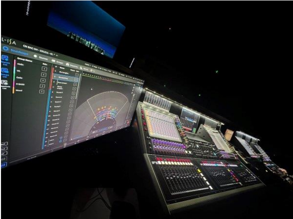
Redundantie in live audio: twee DiGiCo Quantum 5-panels gespiegeld in de FOH-positie van de opera 'The Canal Ballad' tijdens de openingsperformance van het Nationaal Centrum voor Uitvoerende Kunsten in Peking in december 2023. (Foto met dank aan Racpro)
