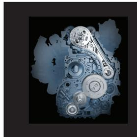
Une distribution par pignons et une chaîne en acier (pas une courroie) assurent la fiabilité.
