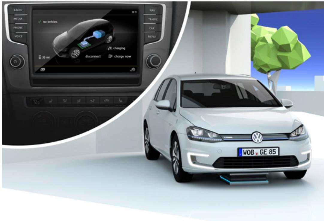
Volkswagen dévoile encore une quatrième innovation à Las Vegas : la e-Golf Intelligent Charge, qui montre comment les voitures électriques recourront à la charge inductive de leur batterie dans le futur. Il suffira à la voiture de se garer au-dessus d'une station de charge par induction. Cette technique permet de se passer des prises et des câbles.
