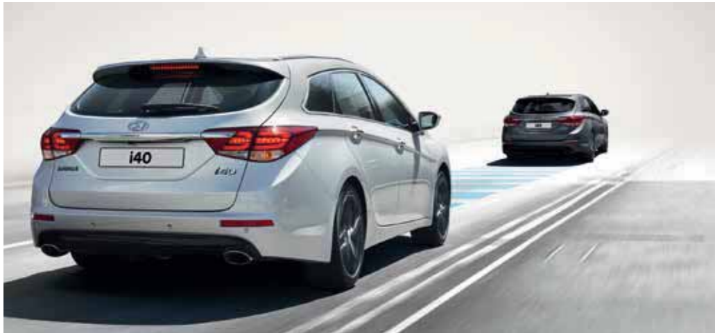
FCA (Forward Collision-avoidance Assist), automatisch remsysteem met hindernis- en voetgangersdetectie
