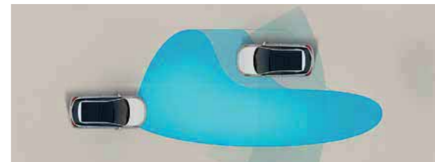
High Beam Assist (HBA) De grootlichtassistent detecteert 's nachts zowel naderende voertuigen als voertuigen in hetzelfde rijvak voor u. Door automatisch de grootlichten in en uit te schakelen, verhoogt dit uw veiligheid en zichtbaarheid in het donker.
