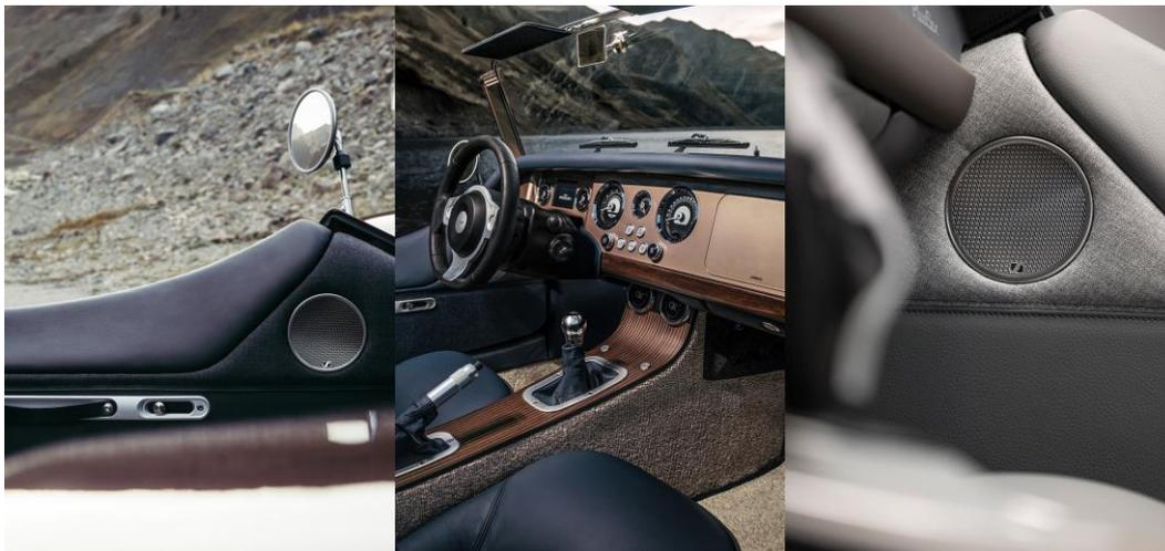
Das System besteht aus acht Lautsprechern: vier konventionellen in den Türen und im hinteren Paneel sowie vier unsichtbaren Lautsprechern, von denen sich drei hinter dem Armaturenbrett und einer im unteren Bereich für die Basswiedergabe befinden. Die Schallwandler werden von einem neuen Verstärker mit eigenem DSP gesteuert, der von der Audioverarbeitungssoftware von Sennheiser profitiert.
