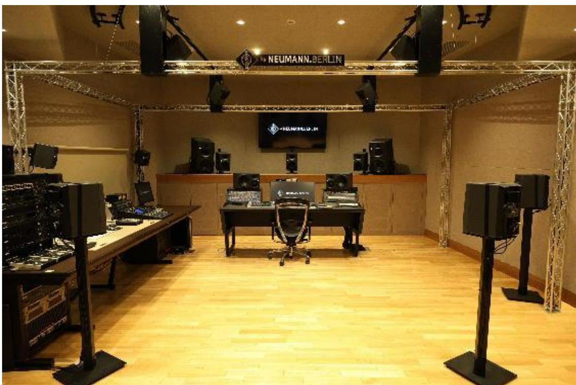
スピーカーのレイアウトは 7.1.4 チャンネル。L/C/R/サイド/リアサイドには「KH 150 AES67」を計 7 台。高さ方向の音を再現するハイトスピーカーにはひと回り小さな「KH 120 AES67」計 4 台。さらにフロント側に 2 台のサブウーファー「KH 750 AES67」を置いています。
