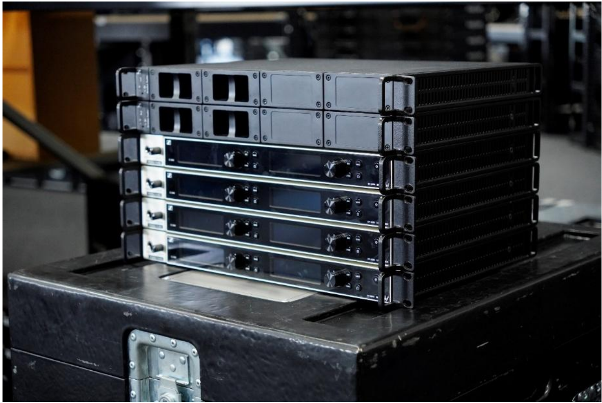
今回導入された2ch受信機 EM 6000 DANTE (下4段)と充電器 L 6000 (上2段)
