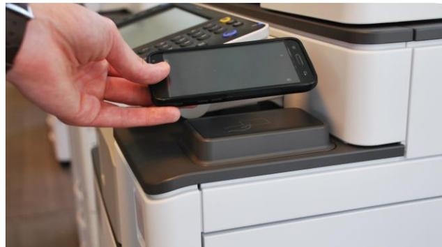
Pour s'identifier, il suffit donc à l'utilisateur d'installer une application sur son smartphone<sup>1</sup> et d'approcher celui-ci du lecteur installé sur l'imprimante ou le multifonction.
