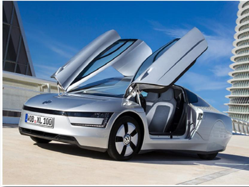
parenté avec le monde des supersportives. Elles sont articulées à deux points, au bas du montant de pare-brise et juste au-dessus du pare-brise dans le cadre de toit, de telle sorte qu'en s'ouvrant, elles pivotent vers le haut et légèrement vers l'avant. Et comme les portes mordent largement sur le toit, l'ouverture dégagée est particulièrement importante, facilitant la montée à bord du véhicule et la sortie de celui-ci.
