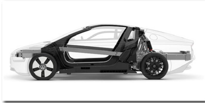
d'un renfort en aluminium destiné lui aussi à absorber l'énergie d'impact. Un cadre de porte rigide en PRFC minimise par ailleurs les intrusions dans la cellule de survie, également en PRFC. Une attention particulière a par ailleurs été accordée à la désincarcération des occupants : si la XL1 reste sur le toit après un tonneau, l'ouverture des portes est facilitée par des écrous à séparation pyrotechnique.
