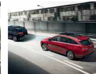
Advanced Smart Cruise Control (ASCC) maintient une distance de sécurité entre le véhicule de devant et ralentit ou accélère lorsque nécessaire.
