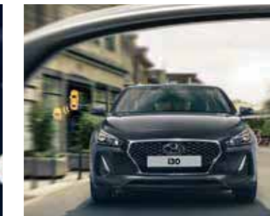
Blind-spot Collision Warning (BCW) prévient la présence de voitures situées dans l'angle mort grâce à des signaux visuels et auditifs.
