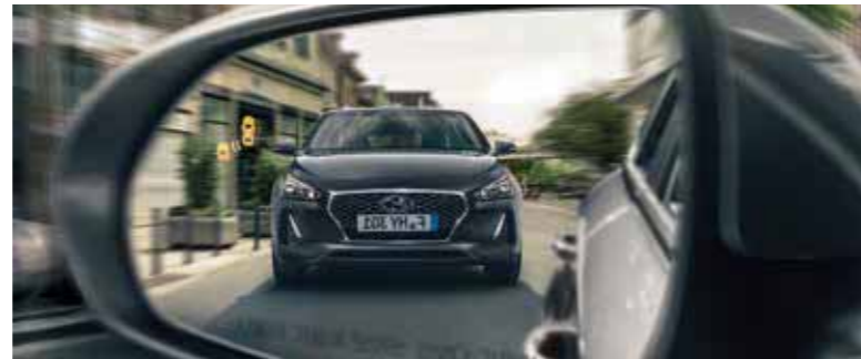
Blind Spot Collision Warning. À l'aide de deux détecteurs radar dans la partie inférieure du pare-chocs arrière, le système vous avertit de la présence de véhicules dans les angles morts. Si vous activez votre clignotant à ce moment-là, une alerte sonore retentit.
