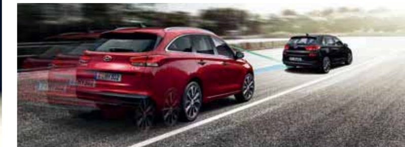
Forward Collision avoidance Assist (FCA) met waarschuwing remt geheel of gedeeltelijk als er een aanrijding verwacht wordt.
