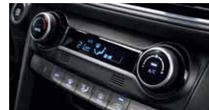
Volautomatische airco met automatisch ontwasemingsysteem
