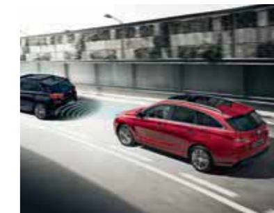
Advanced Smart Cruise Control (ASCC) houdt een veilige afstand tot de voorligger en vertraagt of versnelt automatisch indien nodig.
